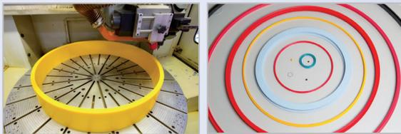
Gedrehte Dichtungen bis 2500 mm Durchmesser
